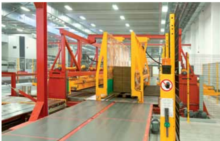
▲ Двойная станция загрузки на паллеты: до 200 погрузок/ч
