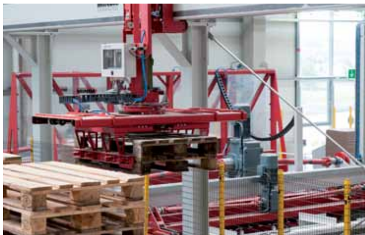
▲ Робот подачи пустых паллет с двумя паллетами в захвате
